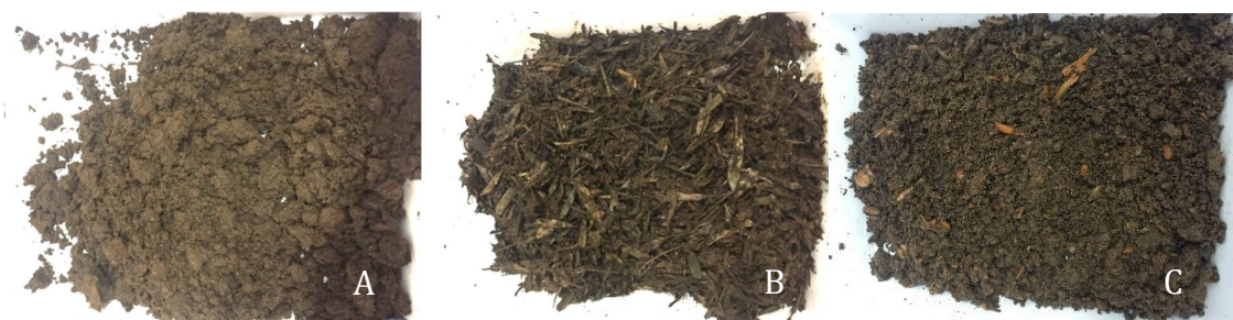
Figura 1. A) alperujo, B) alperujo (85%) y hoja de olivo (15%), C) alperujo (85%), hoja de olivo (5%) y pulpa cítrica (10%)
